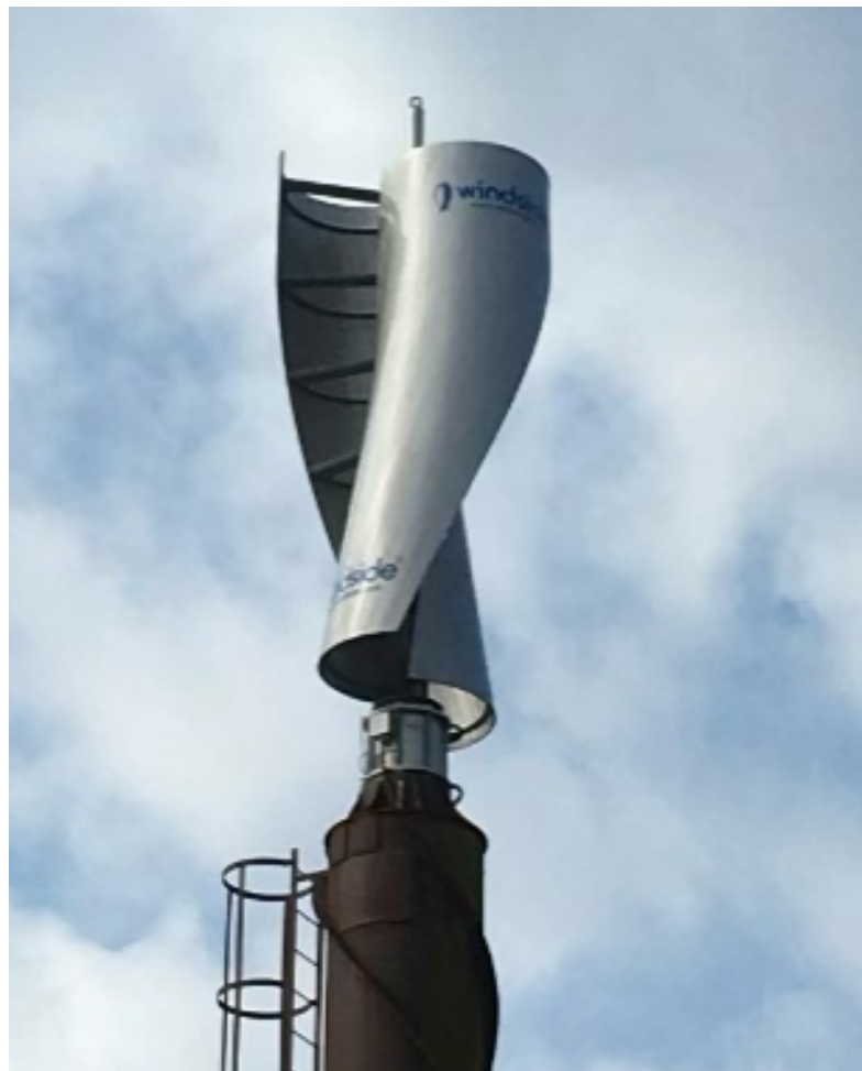
Vertikalt vindkraftverk som fungerar oavsett vindstyrka och är fågelvänligt.
